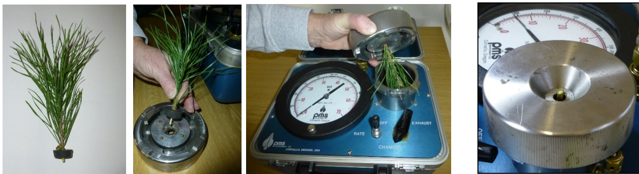
Obr. 2: Postup měření vodního stresu PMS tlakovou komorou
